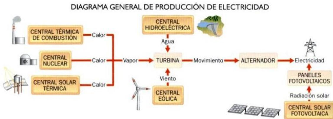
En las centrales térmicas hay un condensador que hace posible que el vapor de agua, a la salida de la turbina, se convierta en agua líquida, para volver a repetir el proceso de calentamiento en la caldera.
